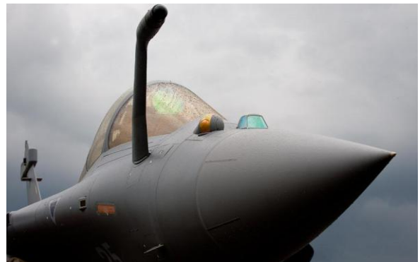
Figure 12. The OSF (Optronique Secteur Frontal) system of the Dassault Rafale.
